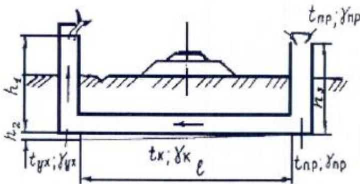
Рисунок Г.3 - Схема к аэродинамическому расчету системы вентиляции защитного кожуха
