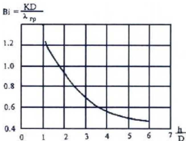
**Рисунок Г.2 - График зависимости критерия  $B_i$  от параметра  $h/D$**
