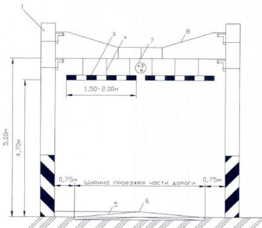
а - с плоской металлической фермой; б - деревянные; в - с металлическими растяжками; 1 - опоры; 2 - металлическая ферма; 3 - ограничительные планки; 4 - металлическая цепь или проволочные подвески; 5 - проезжая часть автомобильной дороги; 6 - сплошная осевая линия; 7 - дорожный знак "Ограничение высоты"; 8 - металлические растяжки
