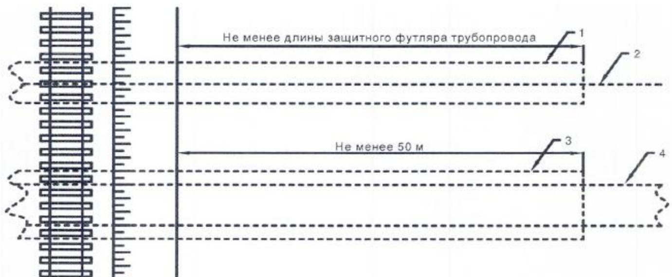
1 - защитный футляр кабеля связи, 2 - кабель связи трубопровода, 3 - защитный футляр трубопровода, 4 - трубопровод.
